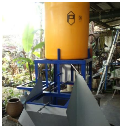
Gambar 2. Pembuatan dan perakitan kerangka alat cuci tangan
