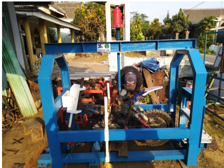
Gambar 5. Mesin press bodi multifungsi setelah dibuat dan diserahkan
