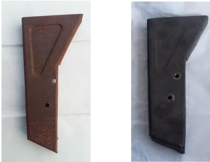
Gambar 7. Produk penyangga samping hasil press dengan (a) tebal pelat 1,5 mm dan (b) 2 mm
