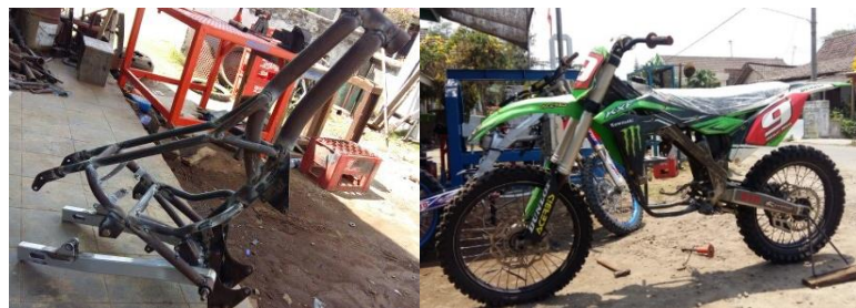
Gambar 2. Tampilan (a) rangka trail setelah pengelasan dan (b) rangka setelah dipasang pada motor trail
