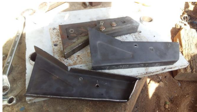
Gambar 6. Penyangga samping setelah dilepas dari mold.
