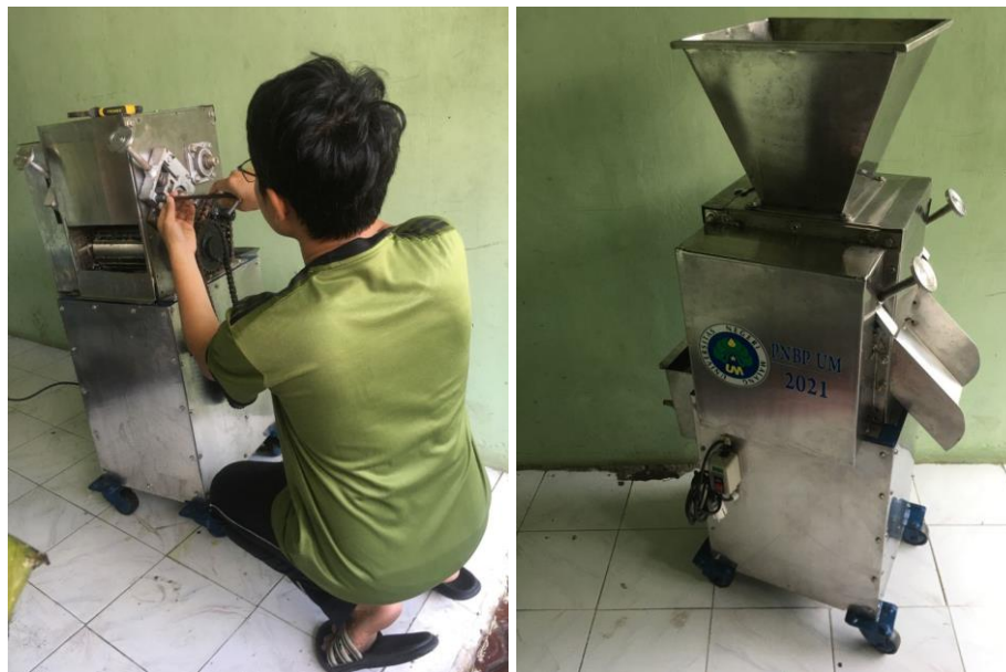
Gambar 6. Assembly dan tampilan mesin pemeras jeruk otomatis
