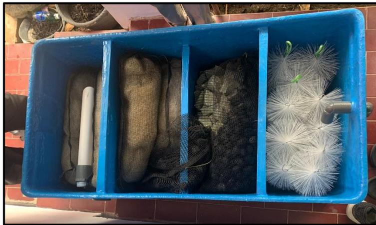
Gambar 3. Perancangan dan susunan Recirculating Aquaculture System (RAS).
