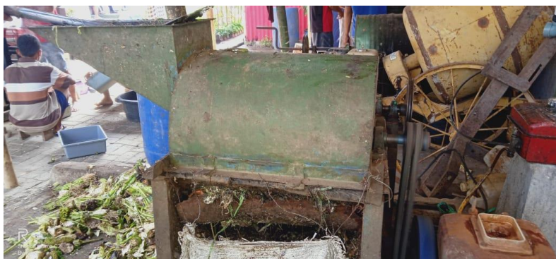
Gambar 3. Mesin pencacah sampah lapis 1 Kota Malang
