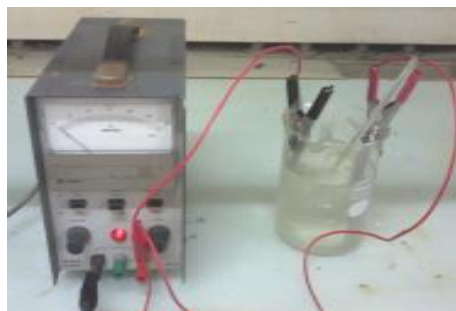
Gambar 3. Rangkaian listrik proses anodisasi.
