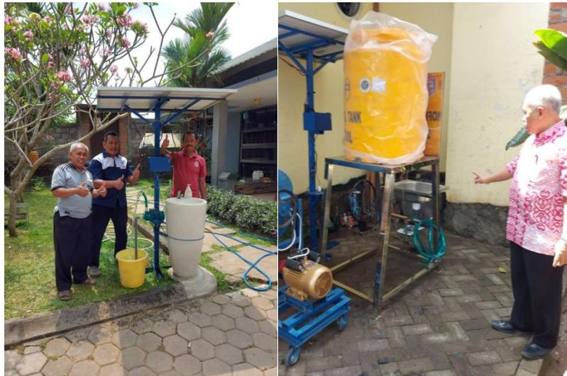
**Gambar 3.** Rancangan Pompa Air Tenaga Surya
