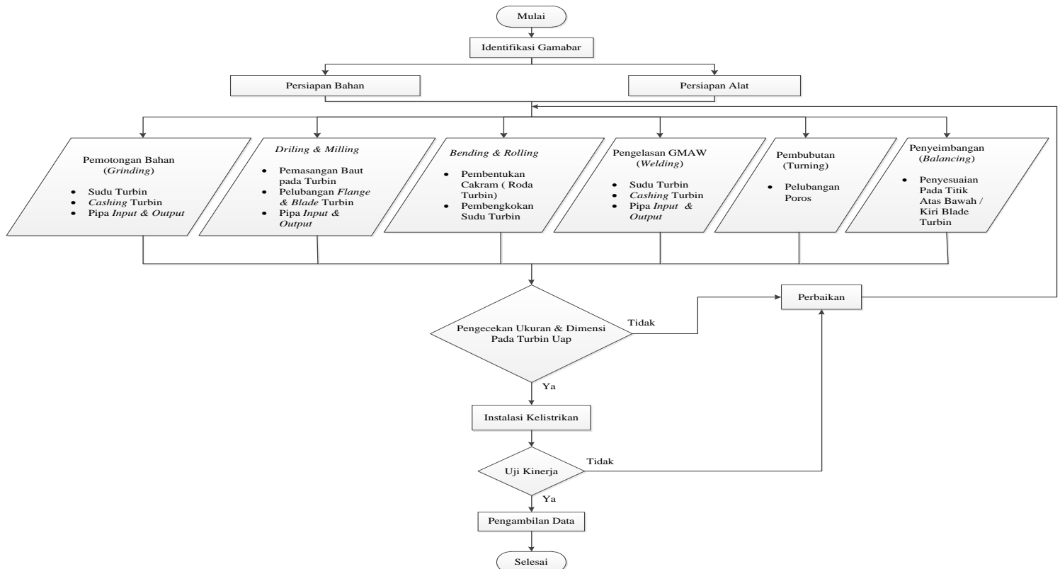
Gambar 2. Flowchart Pembuatan turbin uap
