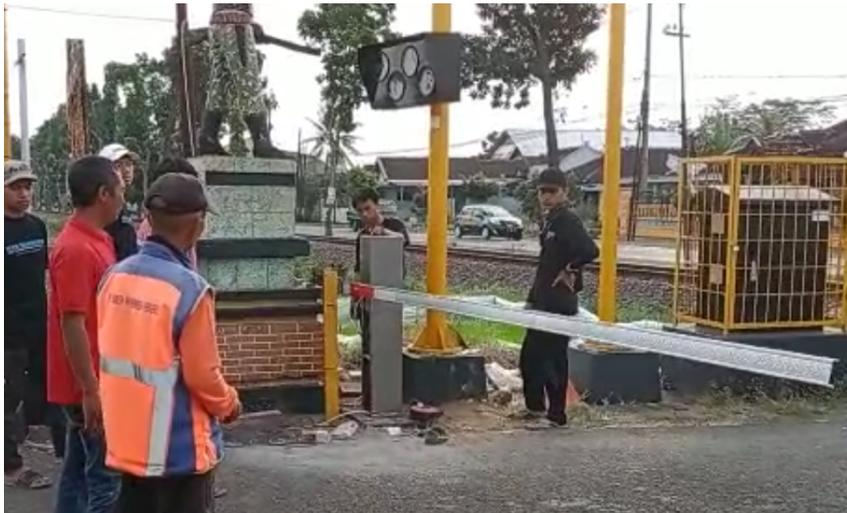
**Gambar 7.** Pengujian palang pintu di persimpangan lintasan kereta api
