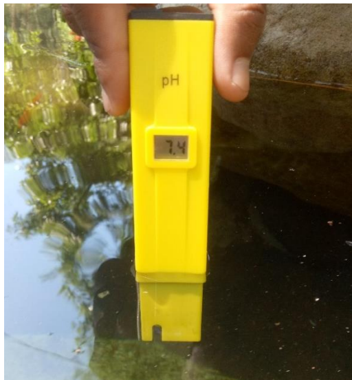
Gambar 2. Pengujian tingkat keasaman air kolam menggunakan pH meter.
