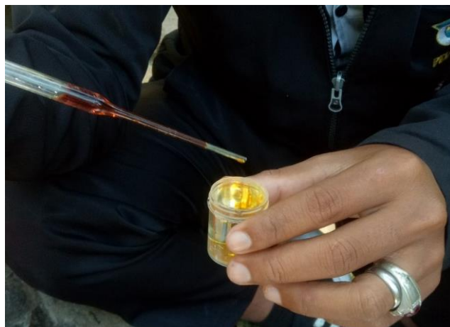
Gambar 3. Pengambilan sampel air kolam untuk uji kandungan kimia dan mikrobial.
