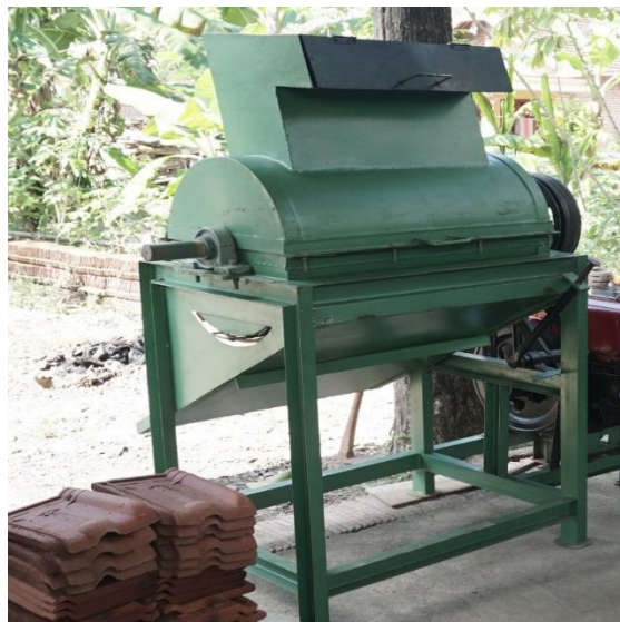
Gambar 3. Hasil Pembuatan Mesin Pemecah Limbah Genteng (Crusher machine) yang Dihilahkan ke Pengrajin Genteng
