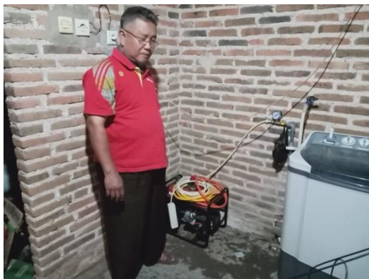
Gambar 5. Pengujian Generator Listrik dengan Bahan Bakar Biogas
