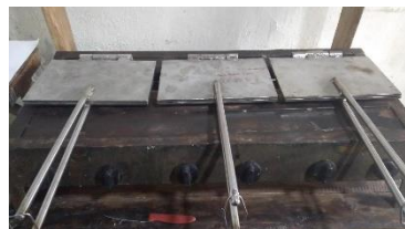
Gambar 4. Cetakan opak stainless Steel 304 yang siap digunakan
