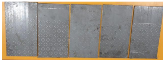
Gambar 3. Pelat Stainless Steel 304 yang telah selesai diukir dengan CNC
