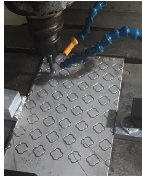
Gambar 2. Proses pembuatan desain cetakan dengan menggunakan CNC
