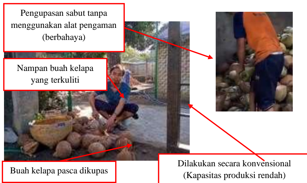
Gambar 2. Proses pengupasan sabut kelapa secara konvensional di Gajahrejo
