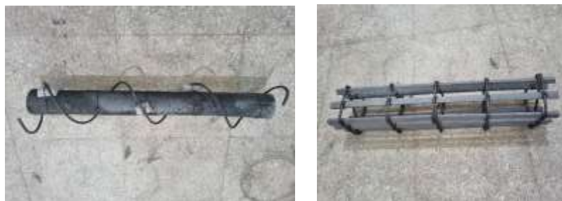
Gambar 4. penulangan bambu utuh (kiri), penulangan bambu persegi (kanan)
