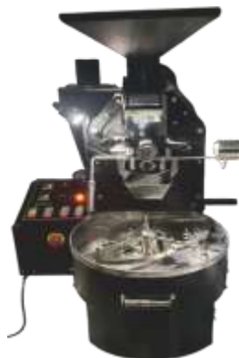
Gambar 1. Desain Mesin Roasting Kopi Berkapasitas 1-1.5 kg/proses
