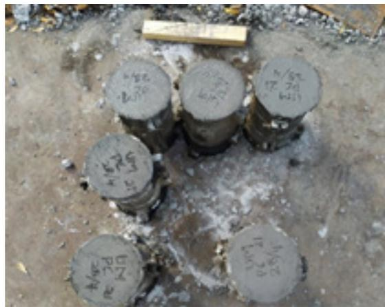
**Gambar 11.** Pembuatan Sampel untuk Pengujian Kuat Tekan Beton
