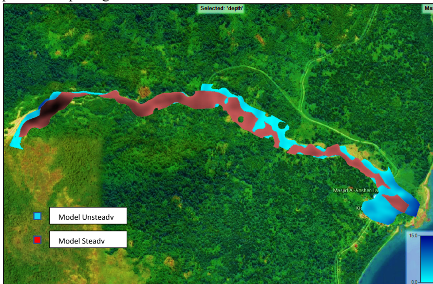
Gambar 8. Perbandingan Luas Genangan Model Steady dan Unsteady
