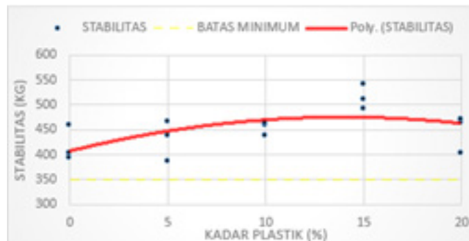
Gambar 5. Hubungan antara Kadar Plastik HDPE (%) dengan Stabilitas (Kg)
