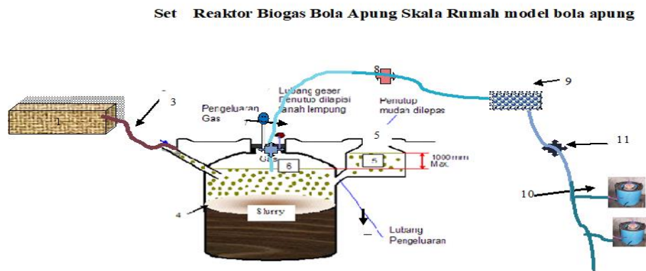
Gambar 1. Skema Reaktor Biogas untuk Mengolah Limbah Ternak Sapi Perah
