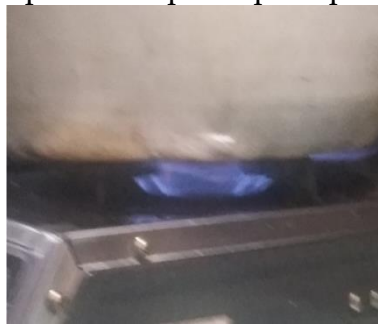
Gambar 7. Kompor Menggunakan Biogas
