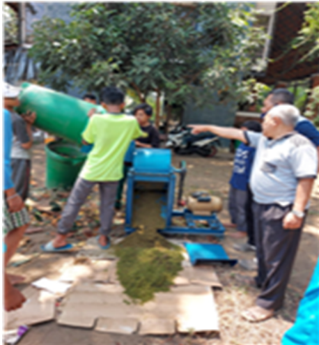
Gambar 5. Uji Kinerja Mesin dengan Sampah Daun dan Ranting
