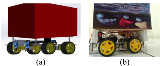
Gambar 2. (a) Desain Kotak Amal Otomatis; (b) Manufaktur Kotak Amal Otomatis
