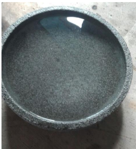
Gambar 7 Uji tes kebocoran glasir batu lava
