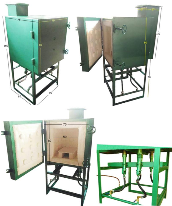
Gambar 5 Dimensi ukuran tungku keramik
