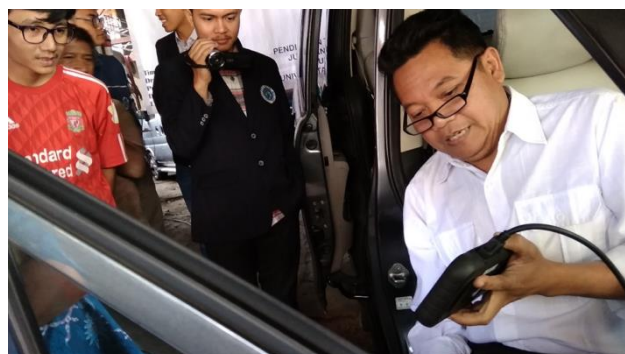
Gambar 6 Cek Fungsi Socket OBD 2
