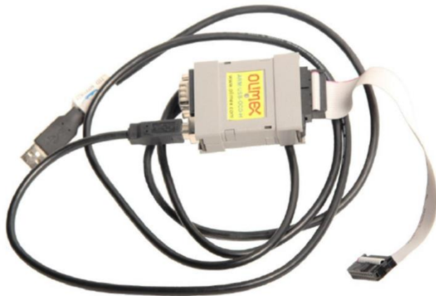
Gambar 2 Desain Device OBD II Ke USB
