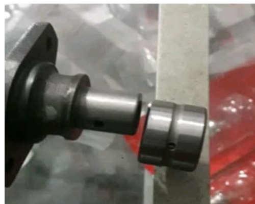
Gambar 5. Ujung Poros Camshaft Yang Sudah Dilakukan Pembubutan
