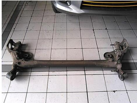
Gambar 1 Suspensi belakang mobil Suzuki ertiga
