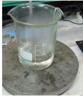
Gambar 6. Penyegelan hidrotermal
