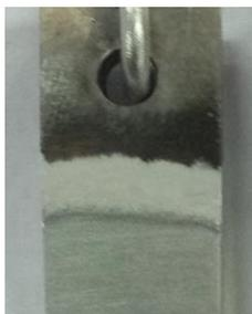
Gambar 10. Sampel dilapisi dengan Anodisasi
