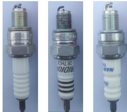
(a) (b) (c) Gambar 3. a. Busi dengan elektroda nikel, b. Busi dengan elektroda iridium, c. Busi dengan elektroda tembaga
