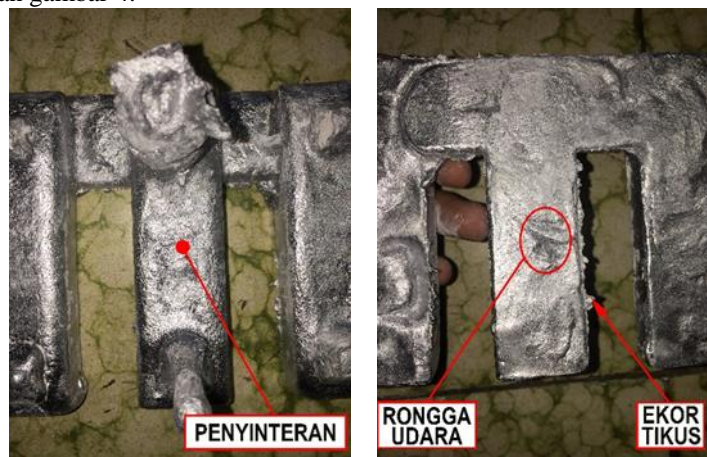
Gambar 2 Pengamatan Hasil Cacat permukaan Coran dengan Komposisi Cetakan Plaster 43% dan Air 57%
