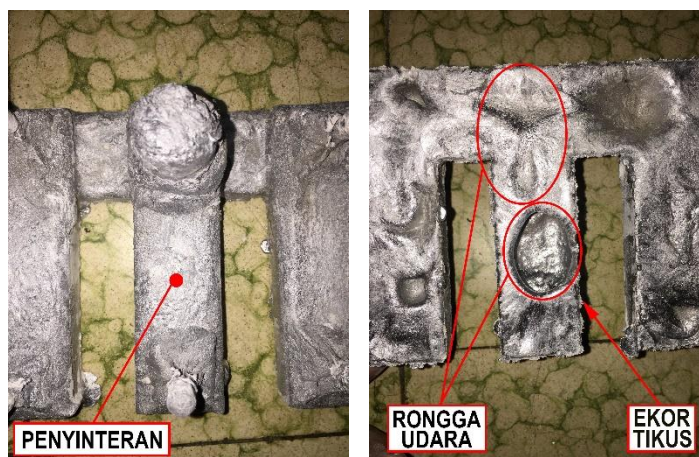
Gambar 3 Pengamatan Hasil Cacat permukaan Coran dengan Komposisi Cetakan Plaster 46% dan Air 54%.
