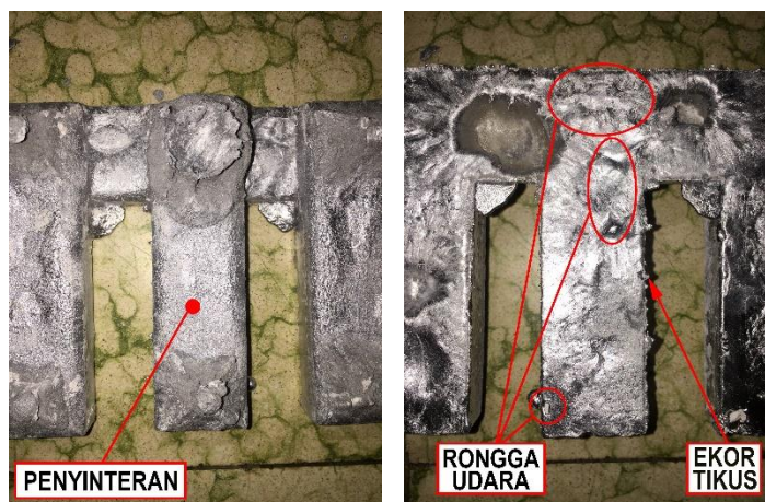
Gambar 4 Pengamatan Hasil Cacat permukaan Coran dengan Komposisi Cetakan Plaster 50% dan Air 50%
