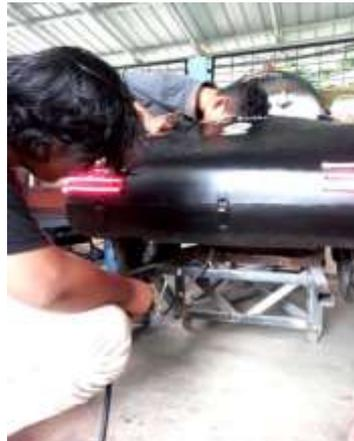
Gambar 9. Proses pemasangan probe sensor pada knalpot mobil Antasari Evo I
