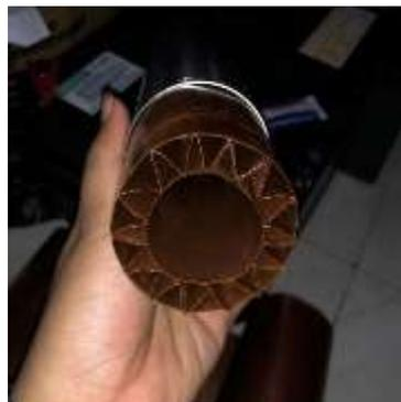
Gambar 5. *Catalytic converter* dimasukkan ke dalam knalpot
