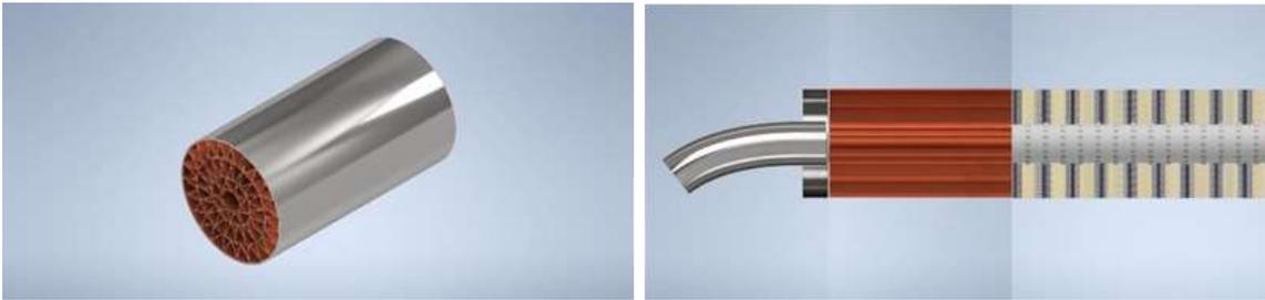
Gambar 3. Rancangan *catalytic converter* dan posisi pada knalpot (potongan)
