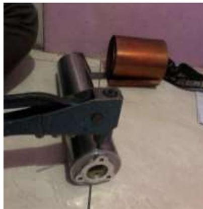
Gambar 8. Pemasangan penutup bracket dengan rivet
