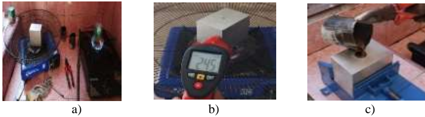
Gambar 5. a) Pemansan cetakan dan limbah plastik PET bersamaan b) Pengecekan suhu cetakan secara berkala c) Penuangan cairan plastik PET ke cetakan
