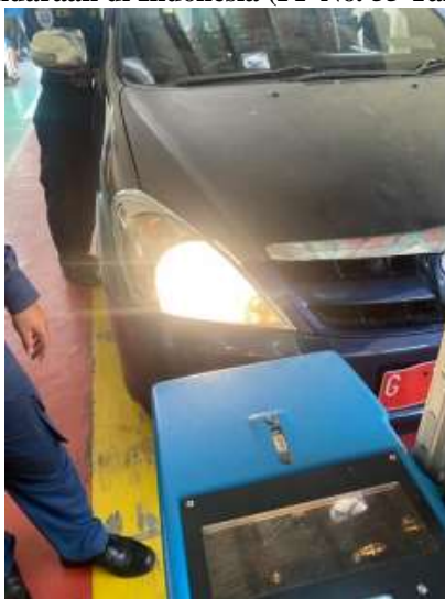
Gambar 1. Standar Pengujian Headlight di Indonesia
