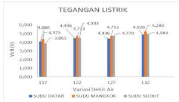
Gambar 2 Hubungan debit aliran air dan bentuk sudu terhadap tegangan listrik
