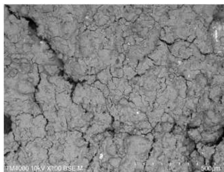
Gambar 11. Hasil Uji SEM diperbesar 500x (pada spesimen V1 dengan matriks 85% dan penguat 15%)
