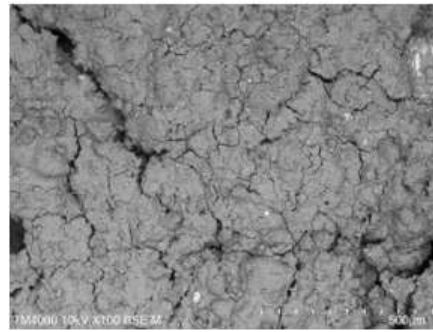
Gambar 9. Hasil Uji SEM diperbesar 500x (Pada spesimen V4 dengan matriks 92,5% dan penguat 7,5%)
