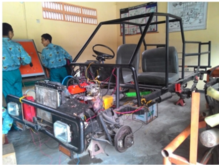
Gambar 3. Trainer motor bensin (Sumber: Dokumentasi 11 November 2015)
