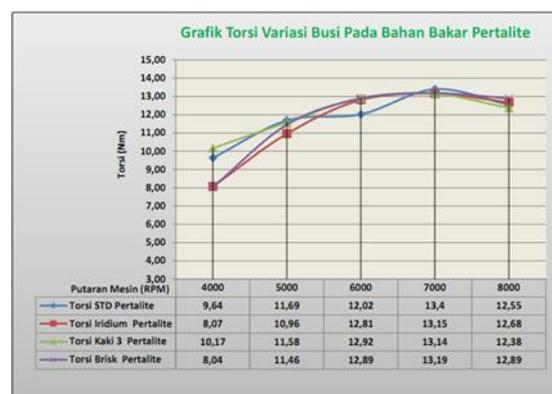
Gambar 4. Hasil Uji Torsi pada Pengujian
