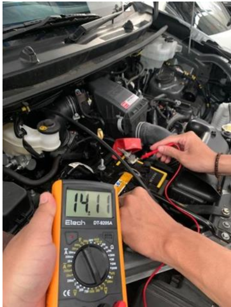
Gambar 4. Pemeriksaan Tegangan Baterai
