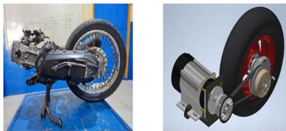
Gambar 8. Pengaplikasian Dinamo BLDC pengganti mesin pada motor
