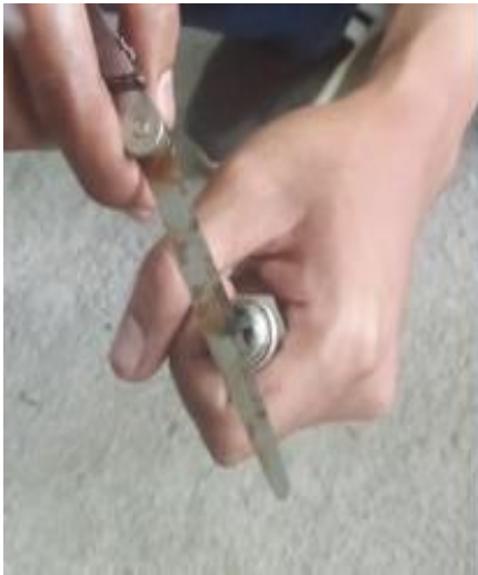
Gambar 1. Konfigurasi celah elektroda busi
