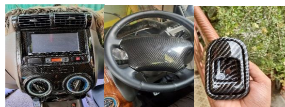
Gambar 3. Pengaplikasian WTP pada Interior Mobil Berbahan Dasar Plastik ABS: a. Frame Headunit, b. Cover Klakson, c. Handle Pintu
