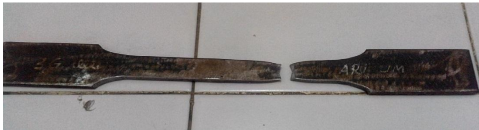
Gambar 5. Baja St.41 Hasil Uji Tarik
