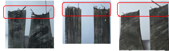
Gambar 6 Bentuk Patahan Penampang Komposit Matriks Resin Berpenguat Serat Alam dengan Tata Letak Woven
