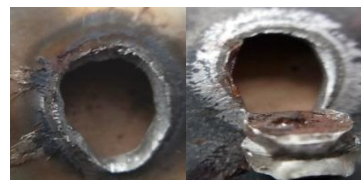
Gambar 3. Hasil Foto Makro Variasi Pengelasan 1 Detik. (a) Baja Tahan Karat AISI 304, (b) Baja Karbon Rendah St 41
