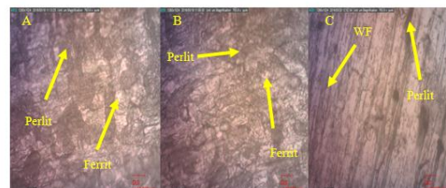
Gambar 8. Struktur Mikro Spesimen Baja Karbon Rendah St 41 dan Baja Tahan Karat AISI 304 dengan waktu pengelasan 1 detik (A) HAZ St 41, (B) Daerah Las, (C) HAZ AISI 304
