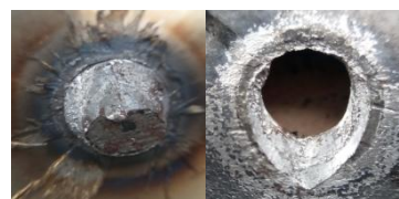
Gambar 4. Hasil Foto Makro Variasi Pengelasan 1,5 Detik. (a) Baja Tahan Karat AISI 304, (b) Baja Karbon Rendah St 41
