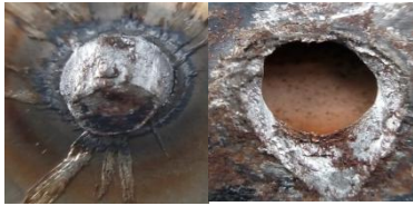
Gambar 5 Hasil Foto Makro Variasi Pengelasan 2 Detik. (a) Baja Tahan Karat AISI 304, (b) Baja Karbon Rendah St 41
