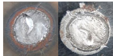
Gambar 2. Hasil Foto Makro Variasi Pengelasan 0,5 Detik. (a) Baja Tahan Karat AISI 304, (b) Baja Karbon Rendah St 41
