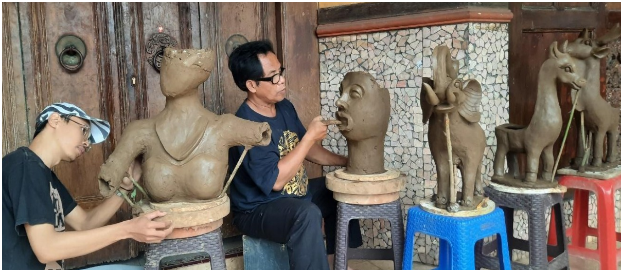
Gambar 3. Proses pembentukan beragam global bentuk dasar wadah terakota sebagai wadah tanaman hias bertema figuratif, dibuat dari tanah liat lokal dengan pembentukan teknik pijatan tangan langsung. Sumber: dokumentasi peneliti, 2023.
