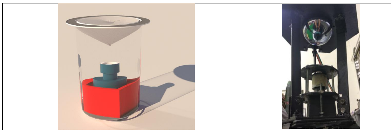
Gambar 2. Rancang kamera omnidirectional yang digunakan robot
