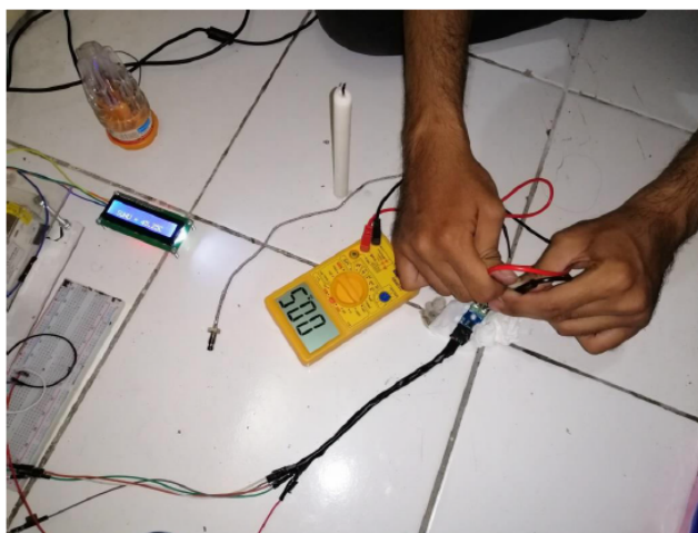
Gambar 4. Pengujian dalam mengukur suhu menggunakan multimeter.
