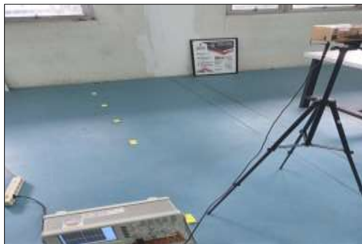
Gambar 5. Pengujian inialisasi sinyal prototipe radar Doppler X-band tanpa objek
